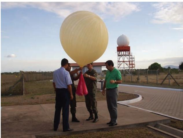
*Lançamento de radiossonda acoplada a um balão meteorológico*
